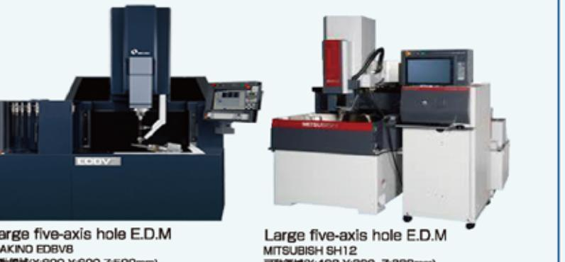
大型5軸穴放電加工機が2台あり、航空エンジンの部品に必要な冷却穴を自動的に開けます。(ブレード、NZL、チャンバーリングなど)
