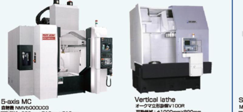
CADデータから、5軸MCと立形旋盤で形状加工を行い、その後の工程で使用する放電電極も加工します。
