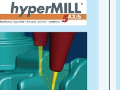
深いキャビティや高さのある立ち壁、アンダーカットなどの加工が複雑な形状は、加工エリアを正確に定義し、多くの工具軸を設定する必要があります。これにより5軸加工の際に起こり得る干渉を回避できます。※CAD/CAMメーカーコメント
